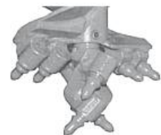
Ostrza z węgla wolframu (widia) do twardego podłoża zawierającego np. kamienie
