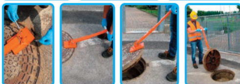
RĘCZNE PODNOSZENIE Z ZABLOKOWANYM POZIOMO UCHWYTEM
