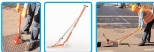
PODNOSZENIE Z POMOCĄ DŹWIGNI APS90 – APS 80
